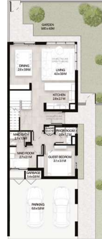
GROUND LEVEL الطابق الأرضي
